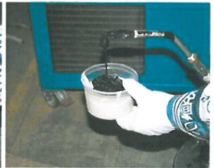
Dozow. żywicy epoksyd. - część B
