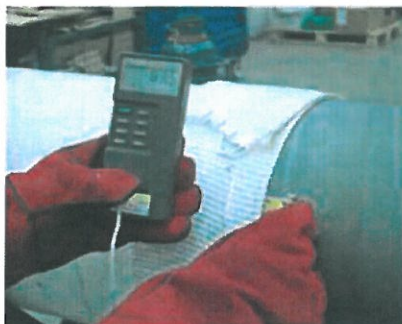
Sprawdzanie temperatury wstępnego podgrzewania na stali (75°C-90°C) lub (167°F-194°F).
