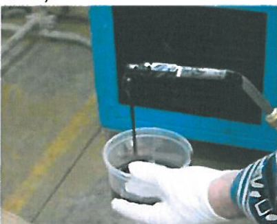
Dozowanie żywicy epoksydowej - część B.
