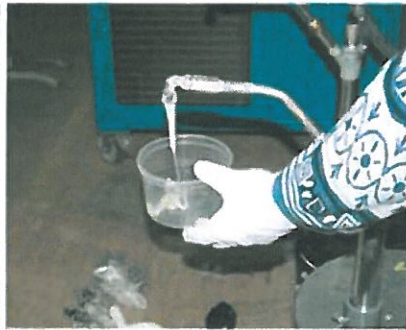
Dozowanie żywicy epoksyd. - część A.
